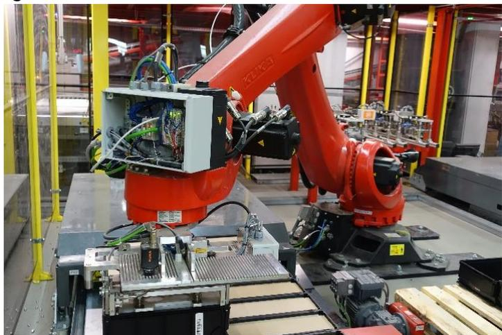
Unser weiterer Roboter ist noch in der Einführungsphase. Seine Aufgabe ist es, einzelne Produktkartonagen im Kommissionierprozess abzugreifen – mit der Hilfe von Vakuum.
