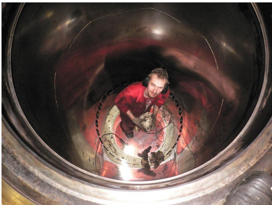
Abbildung 1 Azubizeit, in der Laufbuchse eines 2Takt Motors beim Kolben ziehen
